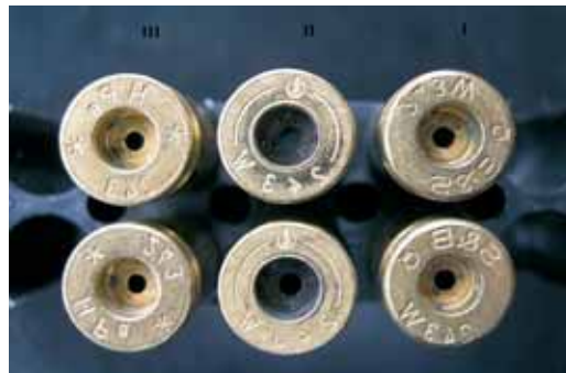
Slika 4: Od šest čahura dvije imaju zacrnjeno ležište užgala
