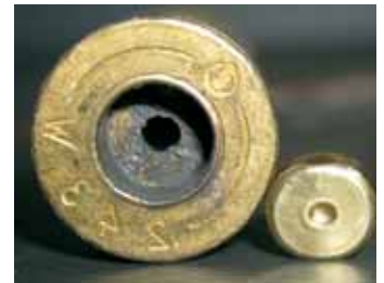
Slika 5: Nakupine ostataka gorenja u ležištu užgala kao kod lošeg elektrovarenja
