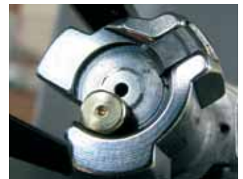
Slika 6: Sagorjeli plinovi probili su se prema natrag i nakupine gareži zalijepile su se na čelu zatvarača
