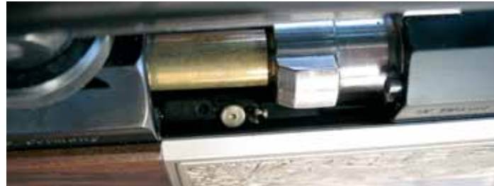
Slika 2: Užgalo i nakovanj iz pretkodne čahure onemogućili su slobodan put zatvaraču
